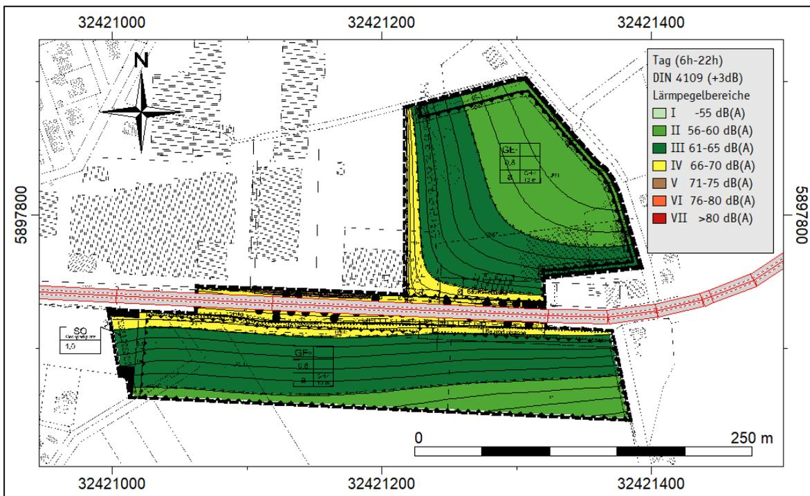
**Abbildung 8:** Lärmpegelbereiche nach DIN 4109-1 und -2 auf Basis der Geräuschimmissionen im Tagzeitraum auf Höhe des dritten Obergeschosses, relative Höhe 10,4 m (hinterlegter Plan: Quelle [10]).
